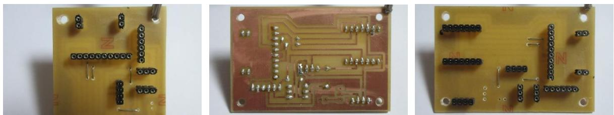
(3)丸ピンソケットも, シングルピンソケットと同様に斜めになっていないことを確認しながらはんだ付けする。丸ピンソケットは6箇所である。
