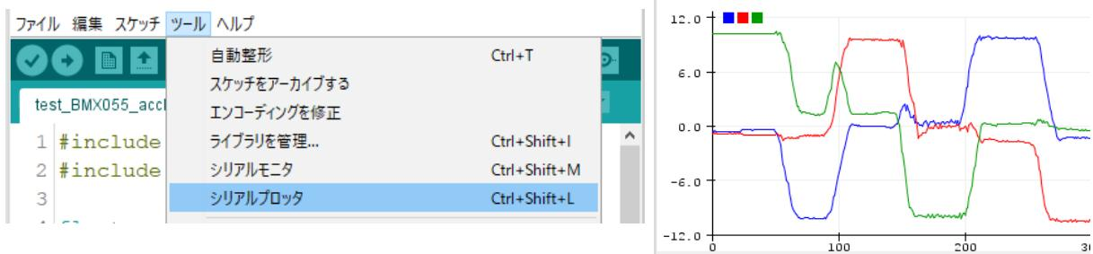
基板を傾けたり動かしたりしてみよう。ディスプレイに示された加速度の値が変化するはずである。静止していても  $0\text{m/s}^2$  となっていないが、これは重力加速度を測定しているからである。例えばセンサの  $x$  軸,  $y$  軸を水平にすると,  $z$  軸方向の加速度が  $9.8\text{m/s}^2$  または  $-9.8\text{m/s}^2$  となる。
