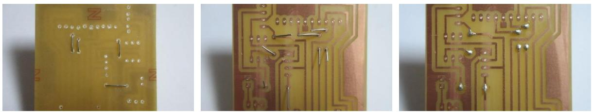
(1)スズメッキ線を写真のようにまげて取り付け, はんだ付けし, 余分な線をニッパーで切る。切るときに基板の銅線を切らないように注意する。
