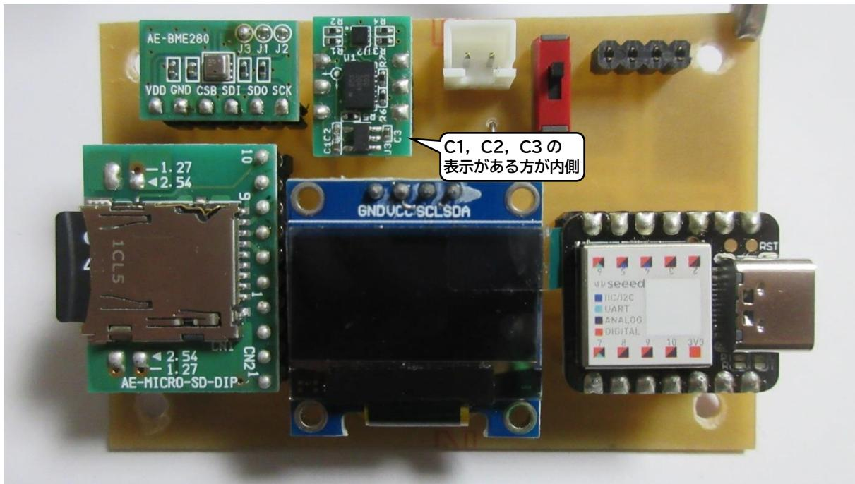
(5) Seeeduino XIAO, OLED, microSD カードスロット, AE-BMX055 (9 軸慣性計測ユニット), AE-BME280 (温度・湿度・気圧センサモジュール) を、向きに注意しながらソケットに差し込む。また、microSD カードをスロットに差し込んでおく。特に AE-BMX055 は向きがやや分かりにくいので、写真をよく見て正しく差し込むこと。この時点では、まだ LM3671 (3.3V DC-DC コンバータ) をソケットに差してはならない。電池も接続してはならない。
