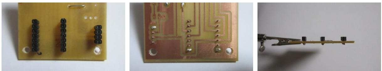
(2)シングルピンソケットを差し込み, 基板に垂直になるように端の一箇所だけはんだ付けする。横から見て斜めになっていたら, はんだを融かして付け直す。
